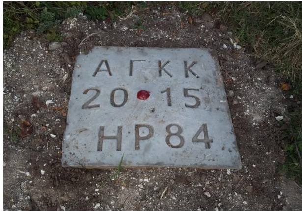
Фигура 8. Стабилизиран гъбовиден болт на терен
