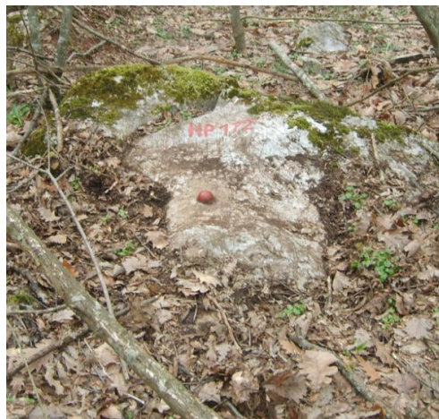
Фигура 9. Стабилизиране на гъбовиден болт в скала
