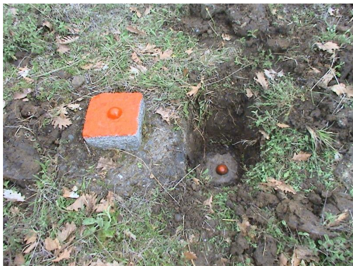
Бетонен блок с подземен и надземен нивелачен знак (код 53)
