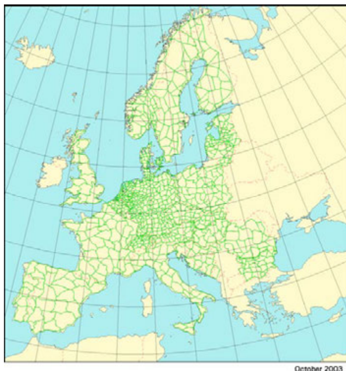
Фиг. 8. Схема на UELN с включена Държавната нивелачна мрежа I клас на България (Sacher et al,2004)
