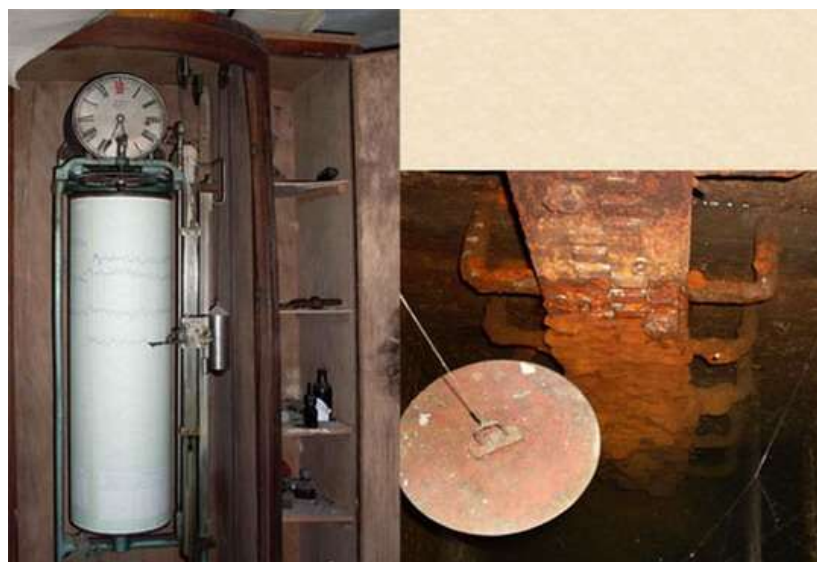
Фиг. 3. Мареографен апарат марка „А.Отт” Kempton
