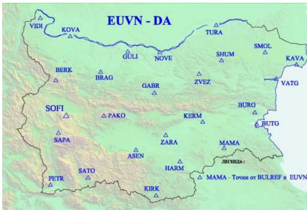
Фиг.7. Точки от официалната реализация на ETRS89 на територията на България. Точките са част от EVRS определени в рамките на европейския проект EUVN_DA
