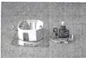
Последователност при разглобяване на димера. В димера е вградено електронно устройство с тиристорно управление на изходящото напрежение
