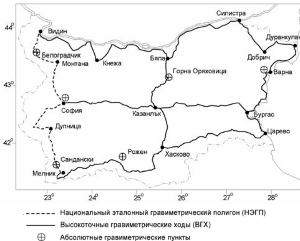
Фиг. 3 Национален еталонен гравиметричен полигон, Прецизни гравиметрични ходове и абсолютни гравиметрични станции (Господинов и др., 2008-2009)
